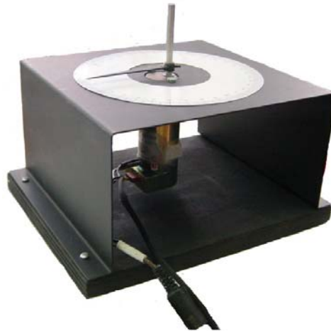
figura 1 – Motore con lancetta, riduttore ed encoder incrementale
